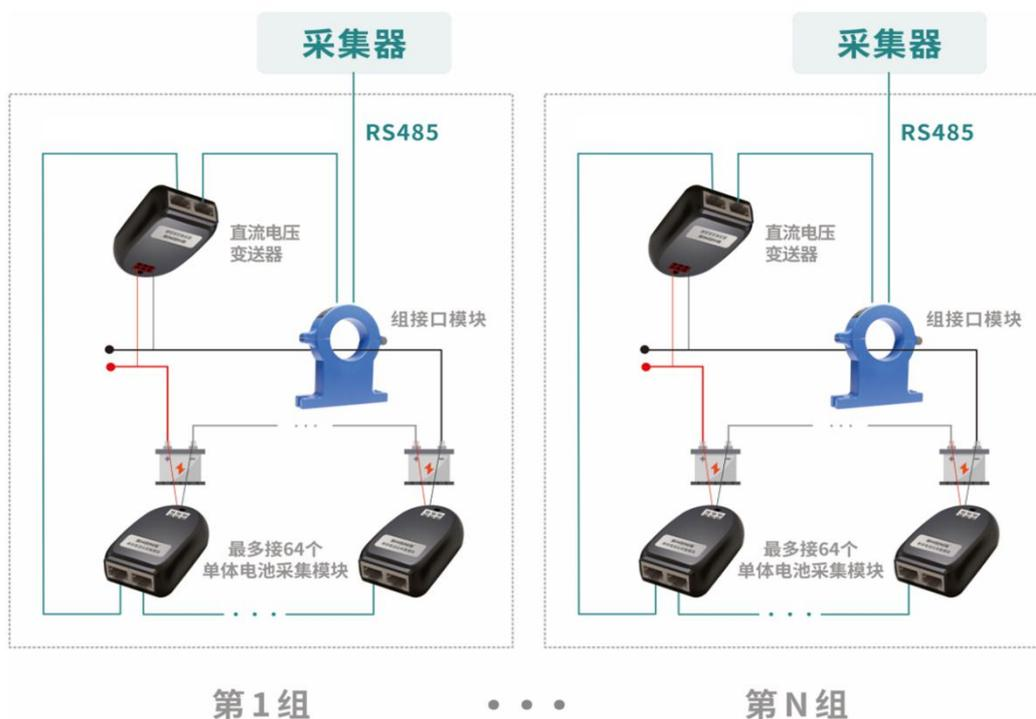
本模块包含3类产品：霍尔组收敛模块、直流电压变送器、单体电池采集模块。直流电压变送器和单体电池采集模块通过私有串口有线通讯方式将数据传至霍尔组收敛模块，霍尔组收敛模块通过RS485方式通讯，将直流电压变送器、单体电池采集模块以及自身的数据上传至采集器，实现蓄电池单体电压、温度、内阻以及蓄电池组电流和电压的在线监测。
