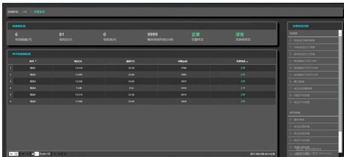
页面内显示电池总数、组电压、告警状态、充放电状态等信息。线面列表内显示单节电池健康状态信息，当故障时显示故障代码，根据故障代码从右侧查看故障说明。系统采集到的电池仪报警数据形成历史记录，用户可随时查阅。点击“历史记录”弹出查询页面，根据过滤条件查询想要的的数据。
